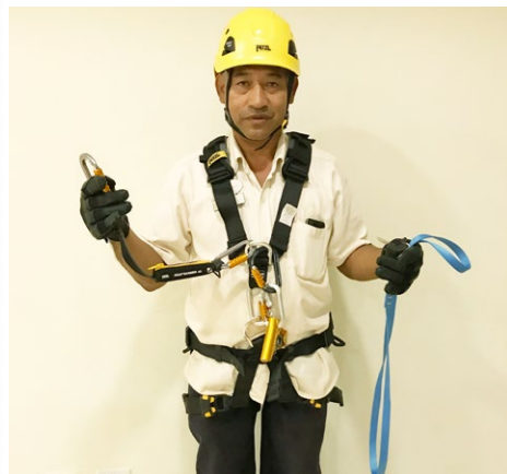
Equipo para trabajos en altura
